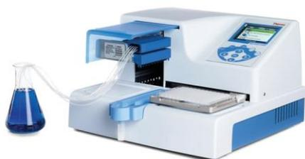
Dispensador de líquidos automatizado projetado para realizar transferências rápidas, precisas e sem contato, ideal para aplicações de alta produtividade em laboratórios, como HTS. Suporta placas de 6 a 1536 poços, dispensando volumes entre 0,5  $\mu\text{L}$  e 2500  $\mu\text{L}$  com alta precisão.
