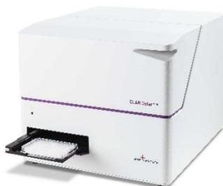
Equipamento versátil que utiliza a avançada tecnologia de *LVF Monochromators™* (monocromadores de filtro variável linear), juntamente com filtros ópticos. Isso significa que ele combina a flexibilidade dos monocromadores com a sensibilidade dos filtros tradicionais.
