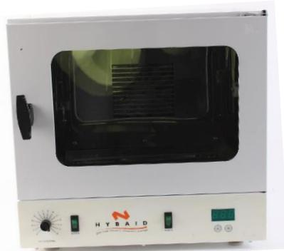
Equipamento projetado para proporcionar um ambiente controlado de temperatura essencial para ensaios de hibridização de ácidos nucleicos. Sua funcionalidade garante a homogeneidade térmica e a uniformidade no processamento de amostras, permitindo resultados reprodutíveis em experimentos sensíveis.
